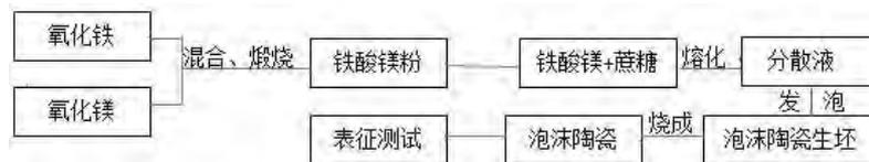
图2 铁酸镁多孔材料的制备工艺流程
